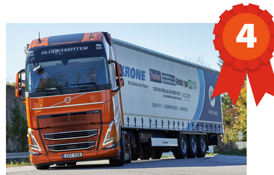
Dank Turbocompound rollt keiner souveräner über die Testrunde als der Volvo FH 460 I-Save
